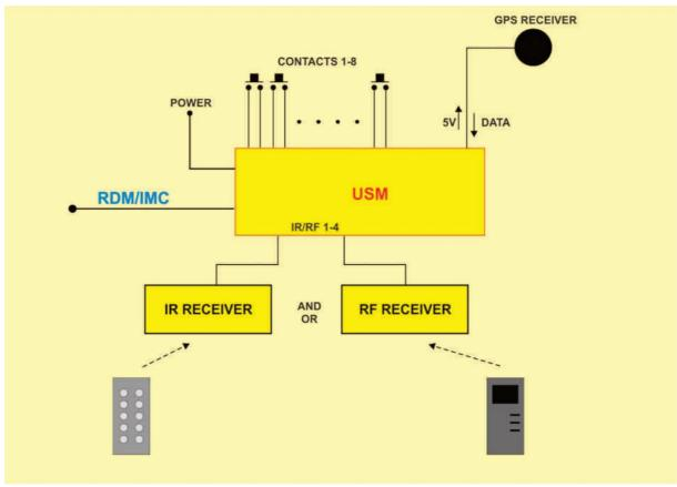
An den RF-IR Receiver Eingang können können gleichzeitig verschiedene Fernbedienungen angeschlossen werden – bis zu vier RF, vier IR Receiver oder gemischt.
